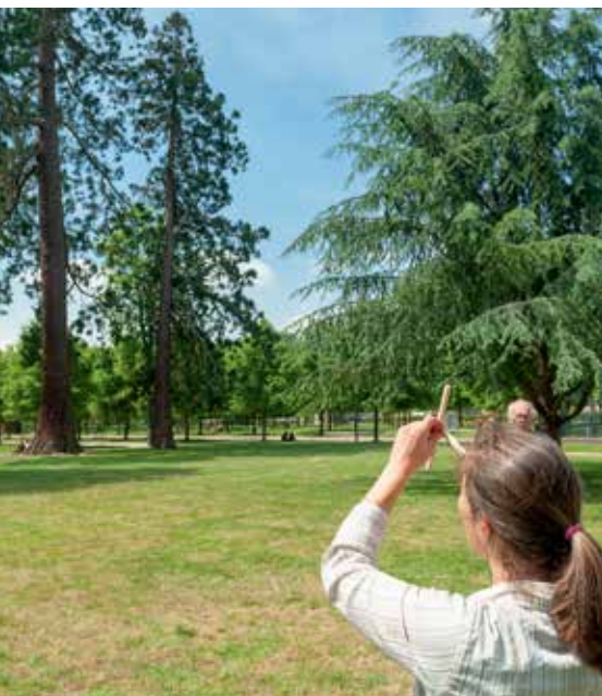
Une méthode pour estimer la taille d'un arbre : la croix du bûcheron, expliquée dans le kit prospecteur
